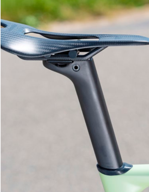
Auch die D-Shape-Carbon-Sattelstütze stammt aus eigenem Haus und bietet sehr ordentlichen Sitzkomfort. Weiteres Leichtgewichts-Highlight ist die grazil Clavicula-Carbon-Kurbel vom Carbon-Spezialisten THM.
