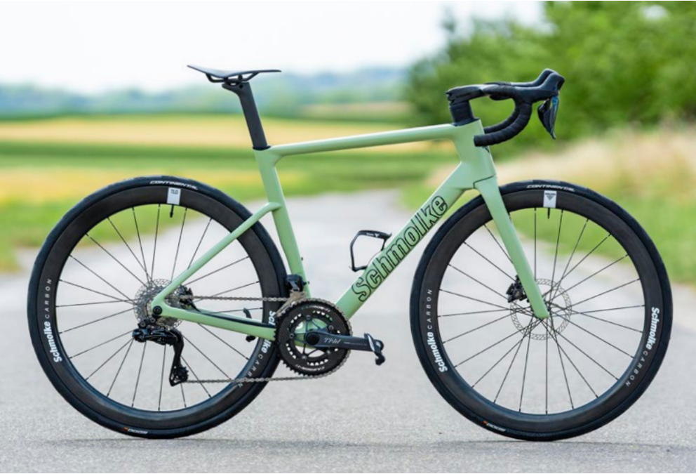
Auch die D-Shape-Carbon-Sattelstütze stammt aus eigenem Haus und bietet sehr ordentlichen Sitzkomfort. Weiteres Leichtgewichts-Highlight ist die grazil Clavicula-Carbon-Kurbel vom Carbon-Spezialisten THM.
