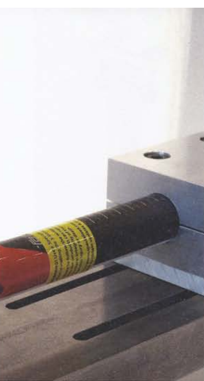
Querovalsierung bei der Syntace P6 HiFlex.
