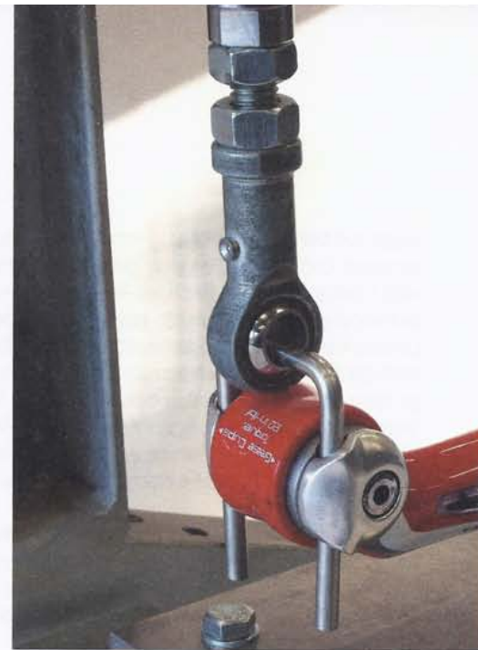
Auf dem Prüfstand wurden die Flexstützen rechtwinklig mit 300 Newton belastet.
